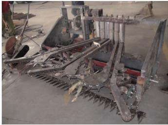
图8 多棱立辊式摘穗试验台
