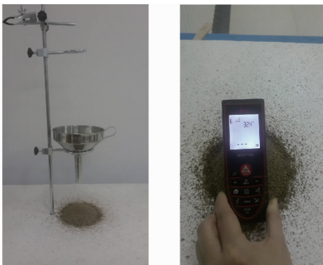
(a) 沙土堆积角测试装置 (b) 沙土堆积角测量
