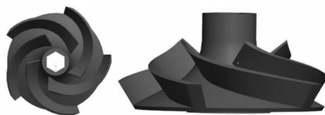
图1 叶轮的三维实体模型
