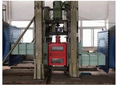
图14 双向流道潜水轴流泵模型装置
