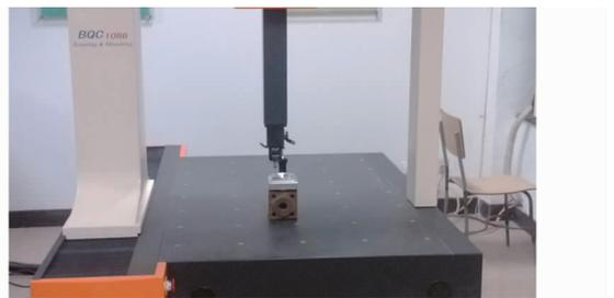
图10 三坐标测量工件误差
