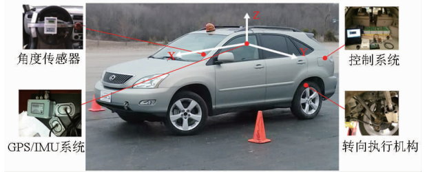
图 14 Lexus 试验车辆的整体设置与安装
