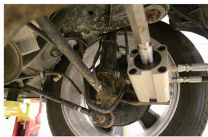
图2 脉冲执行机构的安装
