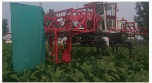
图8 烟草智能打顶抑芽机田间试验
