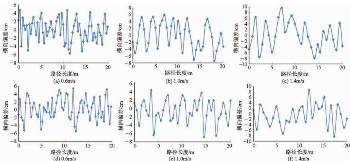
图12 不同速度条件下导航路径跟踪实验结果
