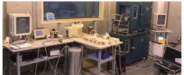
图 2 EGR 冷却器再生试验装置实物图
