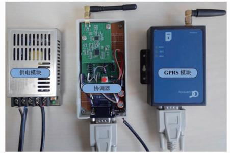
图 2 试验装置协调器的硬件结构图
