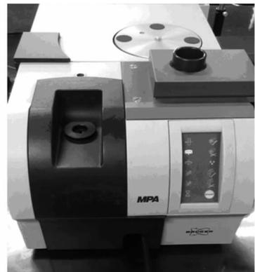
图 2 BRUKER MPA 型漫反射近红外光谱仪
