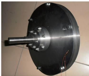
图6 磁流变制动器实物样机
