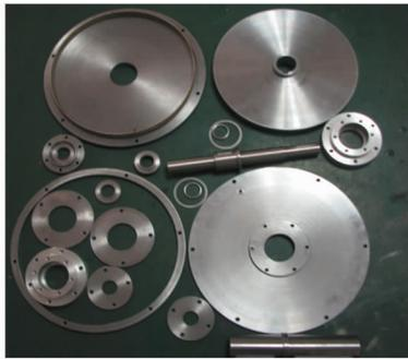
图5 磁流变制动器主要零件
