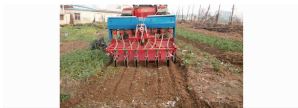
图6 枝状阀式分流装置坡地试验
