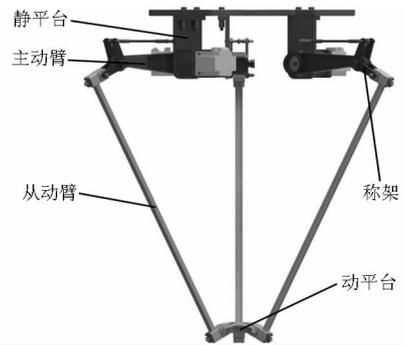
图2 Ahut - Delta 并联机构
