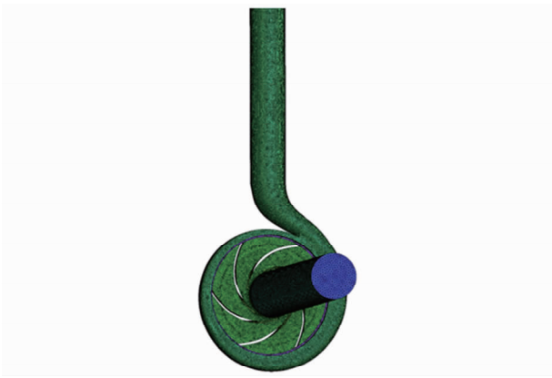
图 3 模型离心泵的网格
