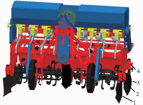
图 1 直播机开畦沟系统安装示意图
