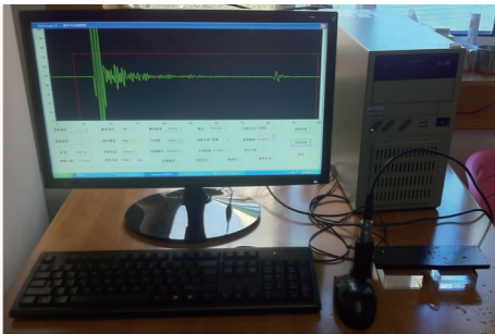
图10 CFRP层板超声信号采集实验设备
