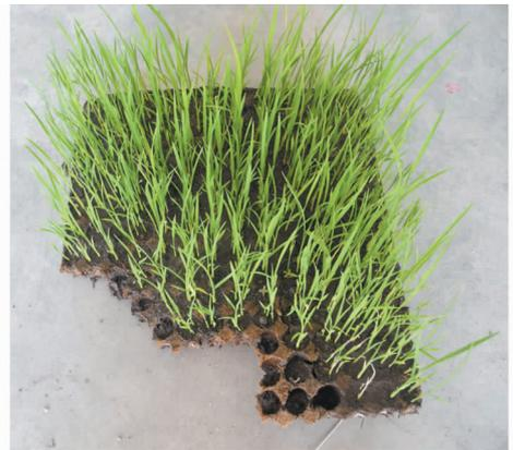
图 3 断裂后的水稻植质钵盘
