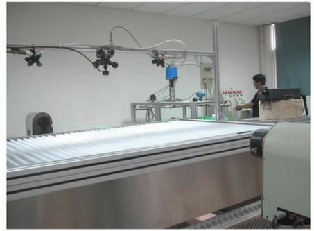
图3 雾滴粒径标定试验
