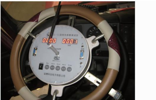
图 13 方向盘参数测试仪
