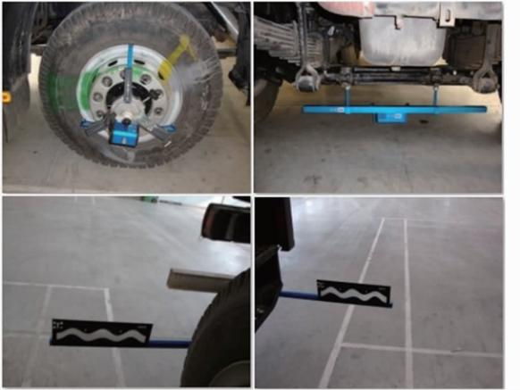
图 12 转向轮定位测试仪
