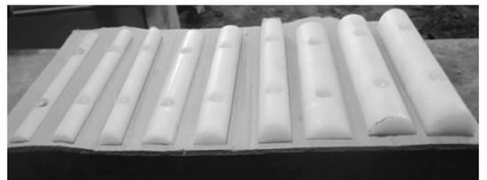
图5 9种UHMWPE肋条结构
