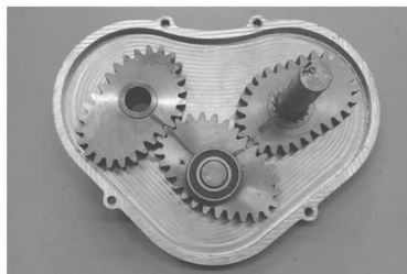
图 5 取苗机构中二阶自由非圆齿轮啮合实物图
