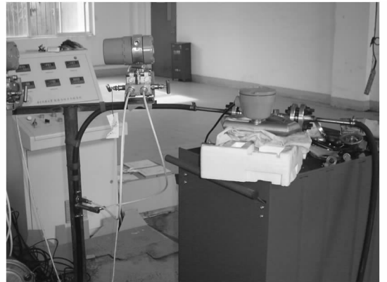
图8 上水孔流量测量技术验证装置图
