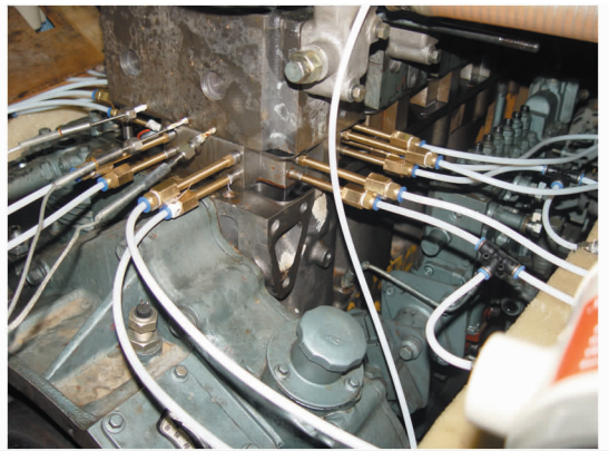
图1 上水孔流量测量实验布置图
