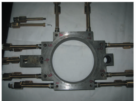
图2 上水孔流量测量装置结构图
