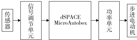
图4 控制系统工作原理
